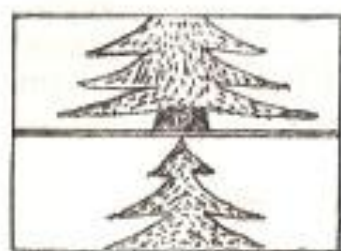
Рис. 6.5. Искажение изображения при отсутствии синфазности
