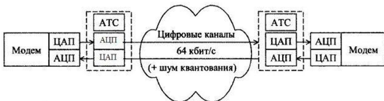
Рис. 3.28. Схема тракта передачи по каналам современной ТфОП
