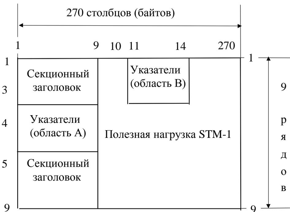
Рис. 2.1. Структура модуля STM-1
