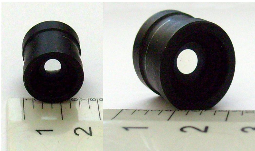
Рис. 3.10. Объектив факсимильного аппарата SAMSUNG SF 2010
