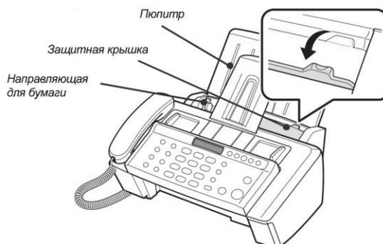
Рис. 4.4. Загрузка обычной бумаги
