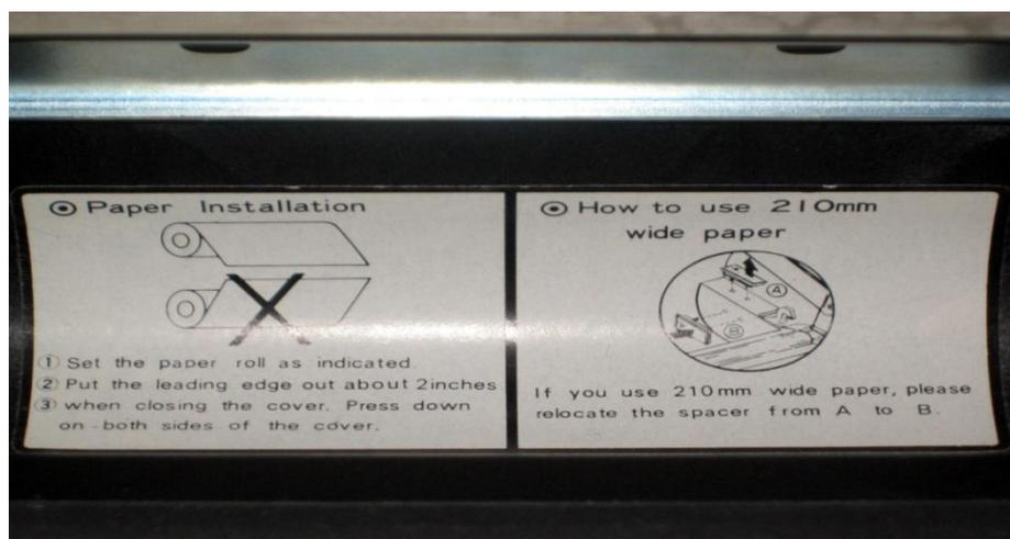
Рис. 3.3. Иллюстрированная инструкция по загрузке термобумаги
