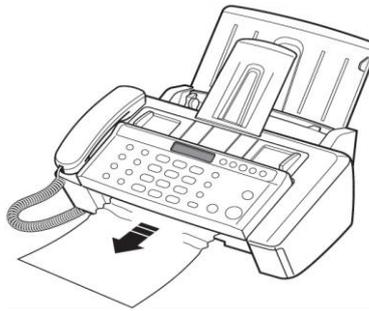
Рис. 4.9. Извлечение бумаги в области выхода
