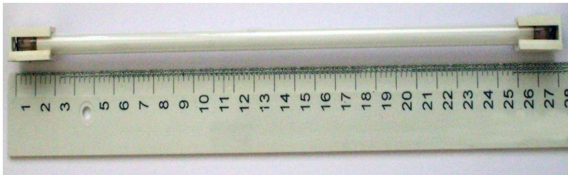
Рис. 3.8. Лампа факсимильного аппарата SAMSUNG SF 2010
