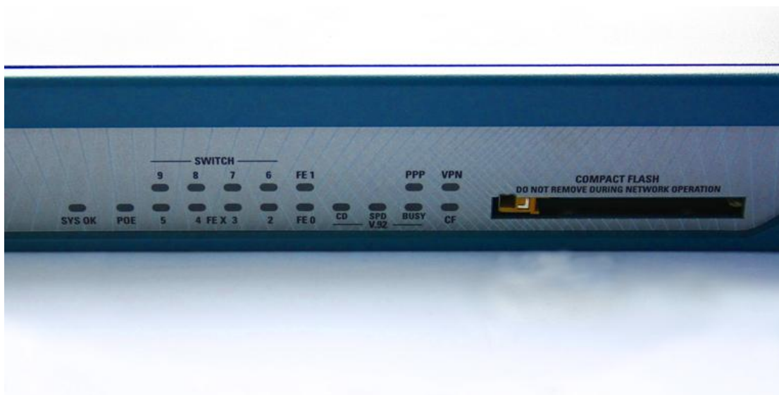
Рис. 3.4. Обозначение световых индикаторов маршрутизатора Cisco 1811
