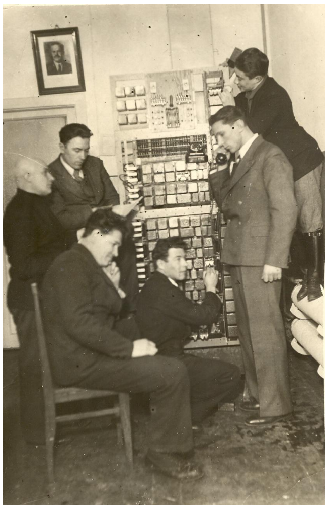
1938 год. Сотрудники Телефонной лаборатории проводят тренировку станции типа OL группы малых АТС
