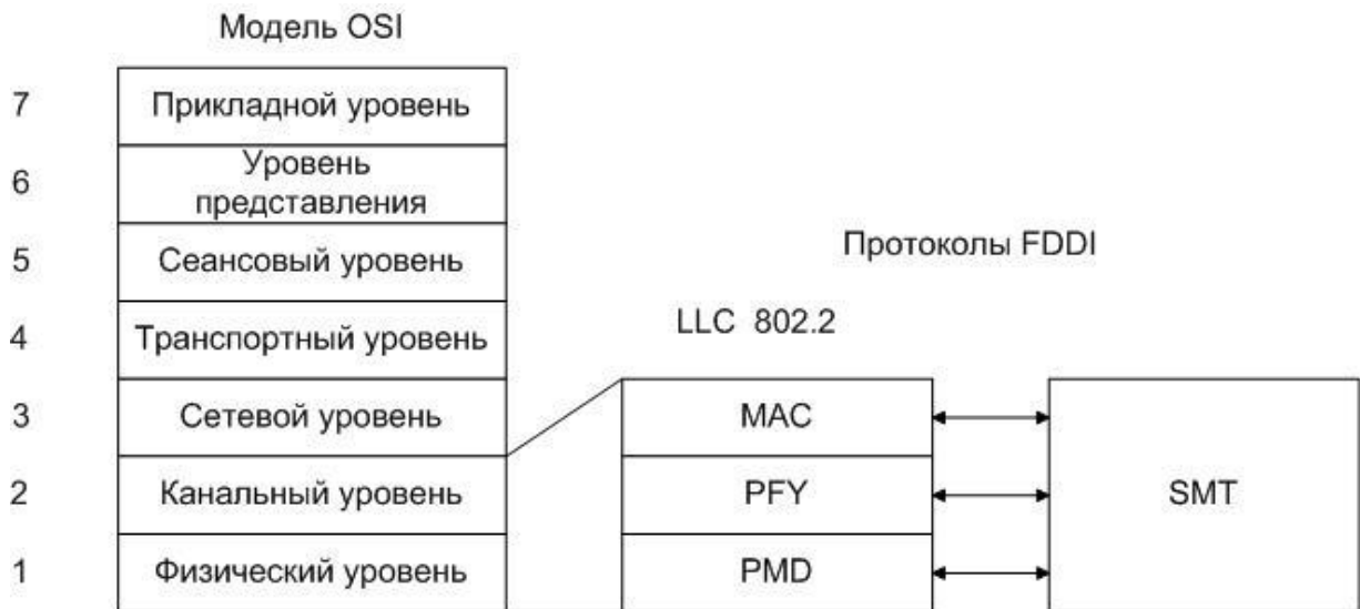
Рис. 2.43. Структура протоколов FDDI
